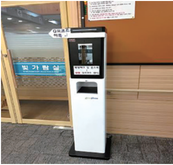
비대면 고열 선별 키오스크 설치
